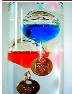
Единственным фактором, определяющим, поднимется или опустится объект в определенной жидкости, является его плотность относительно плотности жидкости. Если объект плотнее жидкости, то он тонет, согласно закону Архимеда, так как он тяжелее жидкости, которую он вытесняет. Причем тонуть он будет
