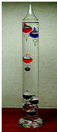
Сам прибор представляет собой герметичный стеклянный цилиндр с прозрачной жидкостью и несколько стеклянных или пластиковых сосудов-поплавков разной массы. По мере изменения температуры отдельные поплавки поднимаются или опускаются пропорционально их соответствующим весам и плотности окружающей жидкости.
